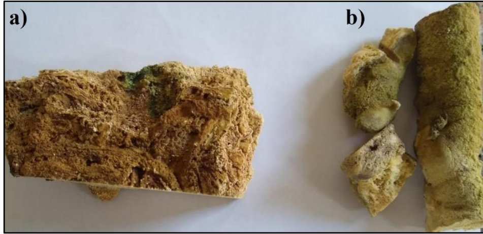
Şekil 4. Aktepe Traverten Köprüsü'nden alınan ve laboratuvar ortamında analizi yapılan traverten (a) ve sarkıt (b) numuneleri.
