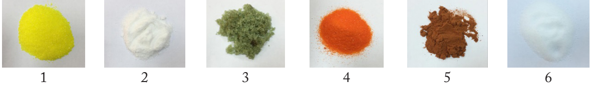
Fotoğraf 7: Kullanılan Mordanlar: Potasyum sülfat (1), Tartarik asit (2), Demir sülfat (3), Potasyum dikromat (4), Tannik asit (5), Sodyum klorür (6)
