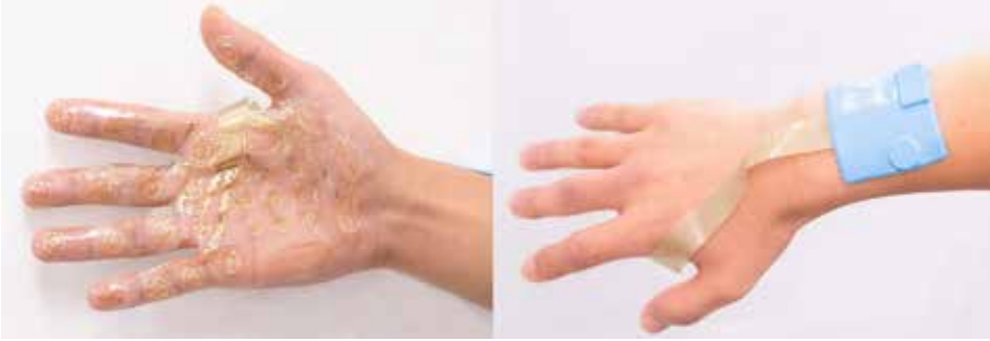
Görsel 4. Giyilebilir "deri" WeTac. Sol: Dokunsal uyarımı sağlayan elektrotları içeren hidrojel avuç içi yamasası. Sağ: Pili ve Bluetooth iletişim ünitesini içeren ünite.
